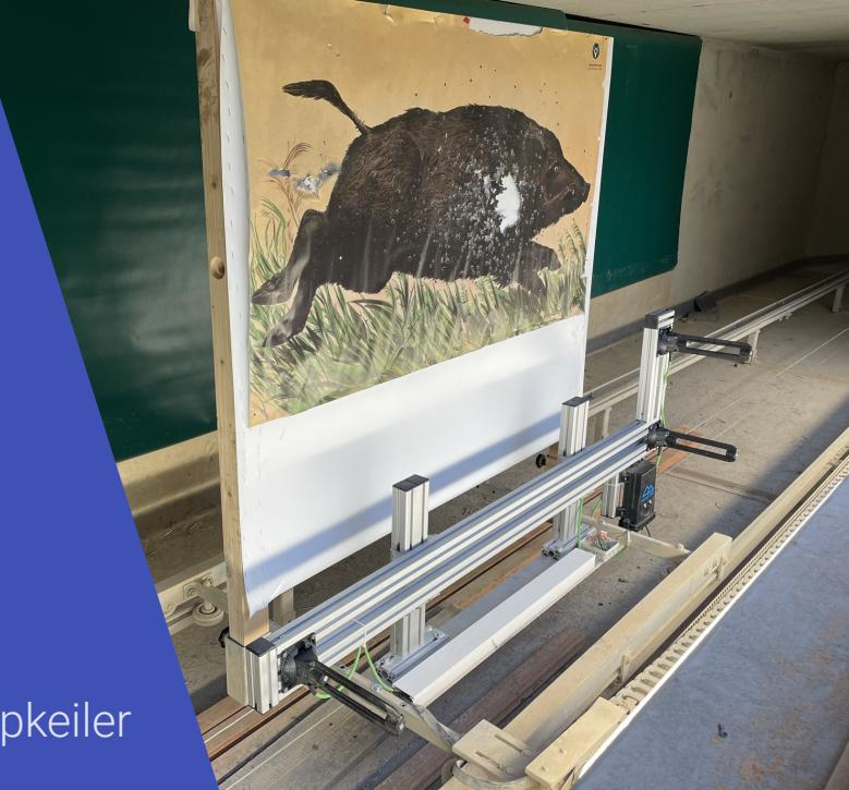
Entwickelt & gefertigt in Deutschland – in Kombination mit dem SPIETH-Schlitten steht das SMT Keiler-System für maximale Präzision, Zuverlässigkeit und Benutzerfreundlichkeit. Eine vollständige elektronische Lösung zur Anzeige von Treffern & ballistischen Daten – speziell für Überschallkaliber im jagdlichen Training.
